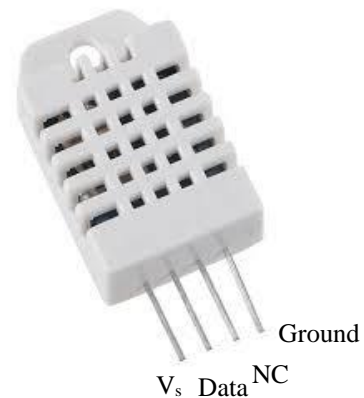
Gambar 4. Konfigurasi Kaki DHT22
