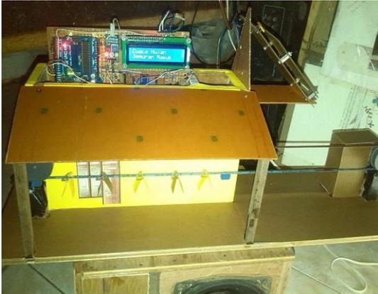
Gambar 11 Pengujian alat ketika cuaca hujan
