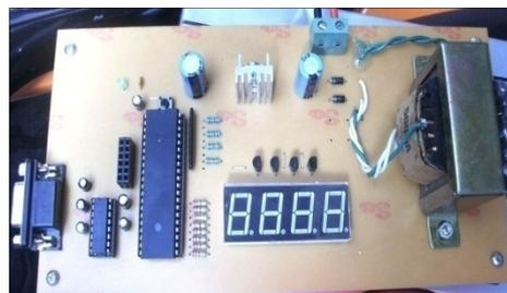
Gambar 11.perangkat keras Master Clock Seven Segment
