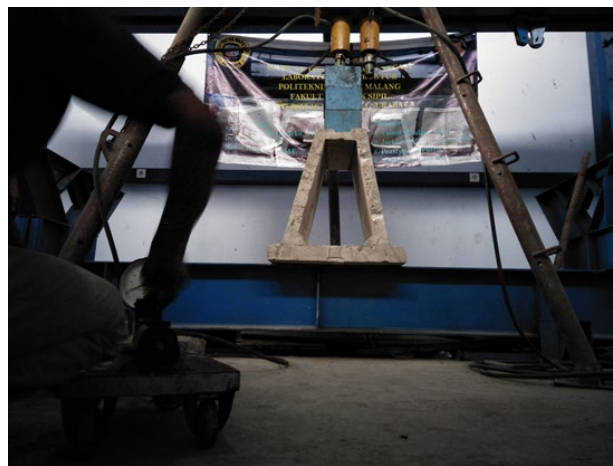
Gambar 5 : Pengujian fondasi pracetak
