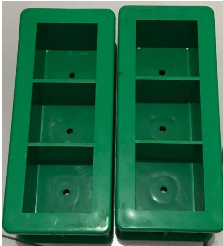
Gambar 1. Cetakan Beton Yang Digunakan. Sumber: Dokumentasi pribadi.
