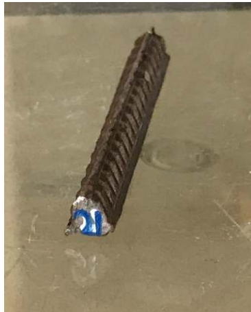
Gambar 2. Besi Tulangan Beton Yang Telah Dipotong Dengan Ukuran 60 mm. Sumber: Dokumentasi pribadi.
